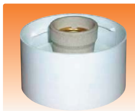
НББ 64-60-080 Основание прямое для светильника Материал: пластик Цоколь параметры/материал: Е 27/керамика Размер основания: Ø 100, высота 50 мм
