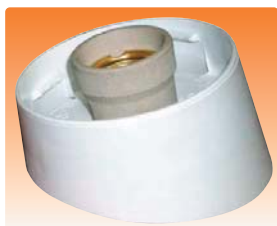
НББ 64-60-080 Основание наклонное для светильника Материал: пластик Цоколь параметры/материал: Е 27/керамика Размер основания: задняя стенка 96x100, высота 54 мм
